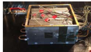
System dummy mit Sensoren (rel.Feuchte, Temperatur, Druck, Betaung)
